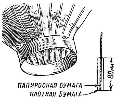
Рис. 26. Выклеивание кольца для горловины шара.
