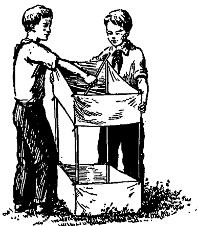
Рис. 36. Определение необходимой длины короткой распорки.
